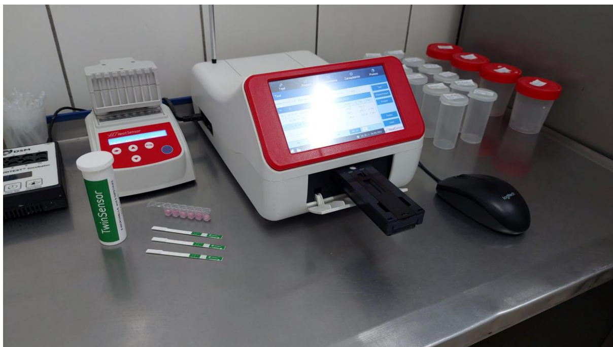
Zdj. 3 Stanowisko do badania zafałszowania mleka antybiotykiem
